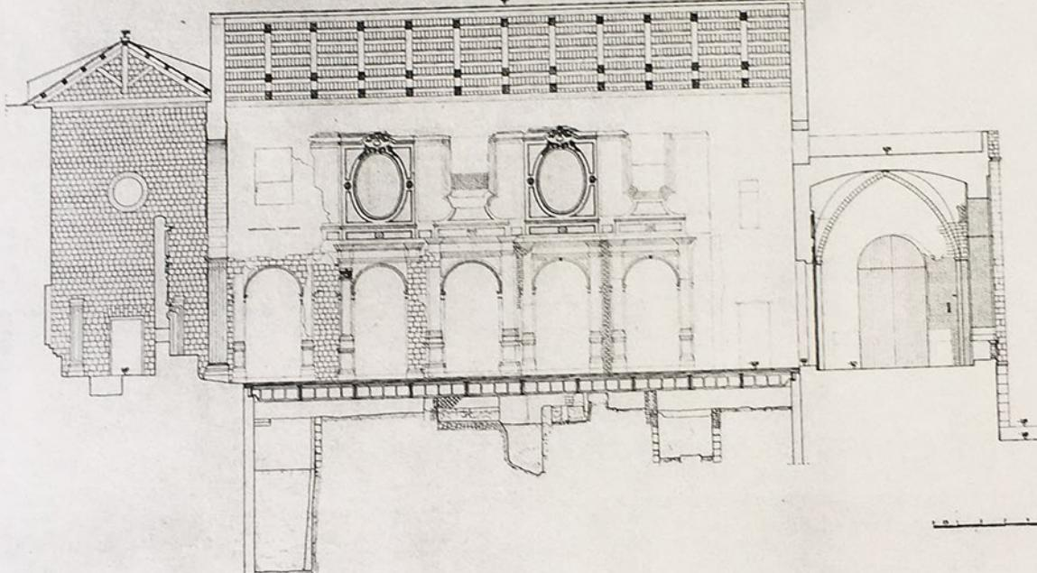
Sezione longitudinale. Da notare la stratificazione costruttiva della loggia d'ingresso con elementi medioevali, rinascimentali e barocchi. Il solaio in ferro che costituisce l'attuale calpestio, ricopre completamente gli scavi archeologici. Il rilievo sotto il calpestio è stato eseguito dalla Soprintendenza Archeologica
