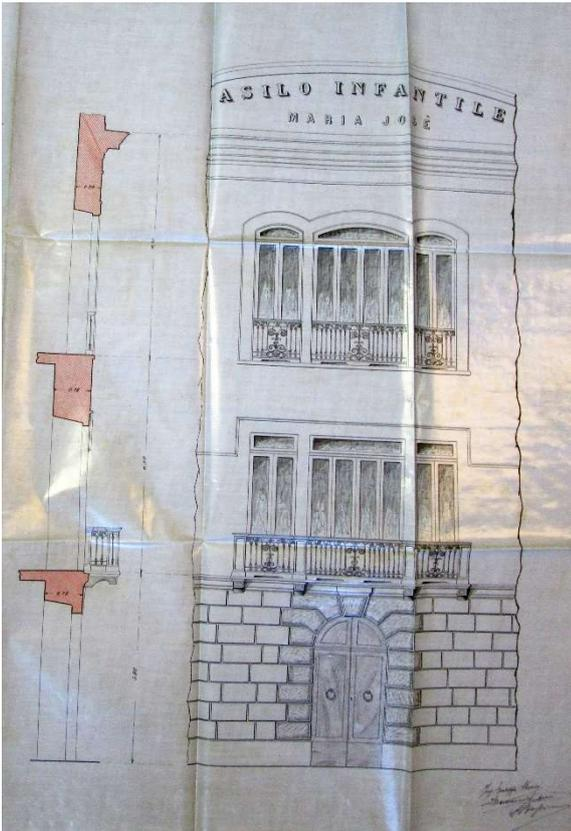
**N. 18 – PARTICOLARE DELLE FINESTRE LATERALI DEL PROSPETTO DELLA NUOVA STRADA ORIENTALE – SCALA 1:20**
